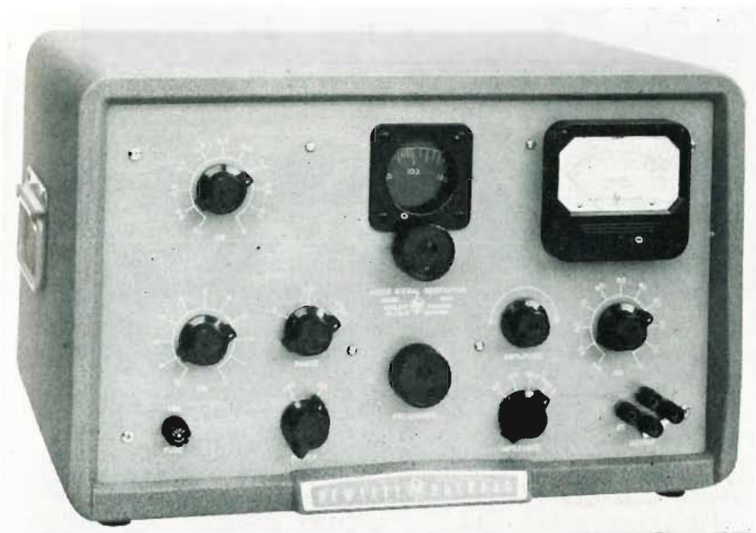
▲ Fig. 1 - Il generatore di segnale audio - hp - modello 206A lavora da 20 Hz a 20 kHz, con meno dello 0,1% di distorsione sopra i 50 Hz.
