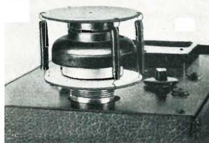
▲ Fig. 2 - Montaggio dell'auricolare per la taratura dell'uscita dell'audiometro.
